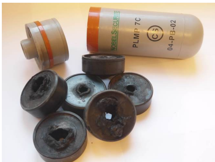
Grenade lacrymogène et ses palets
